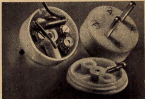
A dugóba épített készülék a fejhallgató-zsinór végződéséhez kapcsolva működik, ha az A-val és F-el jelölt villákat az antennához és a földvezetékhez csatlakoztatjuk
