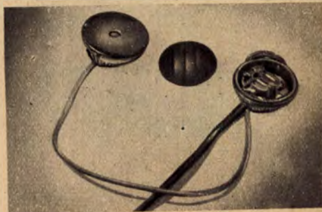
A dugóba épített készülék a fejhallgató-zsinór végződéséhez kapcsolva működik, ha az A-val és F-el jelölt villákat az antennához és a földvezetékhez csatlakoztatjuk
