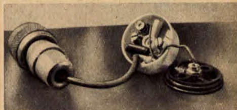
A kinyitott villásdugó. Mivel mindkét villáját lefűrészelték, az antennabevezetést a banánehüvellyel kombinált összeszorító csavarhoz kell dugaszolni
